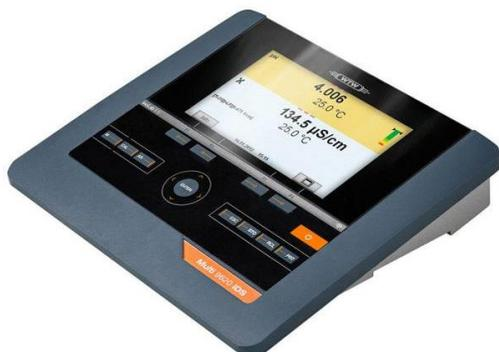
Цифровой, высокопроизводительный, многопараметровый измерительный прибор с двумя входами для проведения измерений pH, ионоселективными электродами, проводимости и содержания растворённого кислорода с всеобъемлющим функционалом надлежащей лабораторной практики (GLP)
