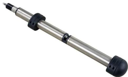
NitraVis® 700 IQ (TS): датчик со встроенной ультразвуковой очисткой для измерения содержания нитрата и взвешенных твердых частиц без реагентов (опция) - оптимизирован для работы в системах очистки городских сточных вод
